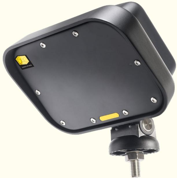
Der Detektor wurde zum Zwecke der Erfassung und Überwachung stehender Fahrzeuge an der Haltelinie entwickelt. Der 316 FMCW Radar arbeitet im 24GHz Band. Zufließende Fahrzeuge werden einzeln durch die Detektionszone getrackt und erzeugen einen Anwesenheitsimpuls, sobald sie zum Stehen gekommen sind.
