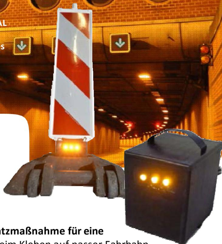
LUMIBOX ist ein ideales Leuchtmodul als **Ersatzmaßnahme für eine Gelbmarkierung**, welche häufig zu Probleme beim Kleben auf nasser Fahrbahn oder bei speziellen Fahrbahnbelägen führt. Die Leuchtmodule werden **in den Bakenfuß von Leitbaken** eingesetzt, wodurch wird eine Markierungsleuchtkette nachgebildet wird, um den Verkehr bei Fahrbahnverschwenkungen, Baustellen, usw. präzise zu leiten.
